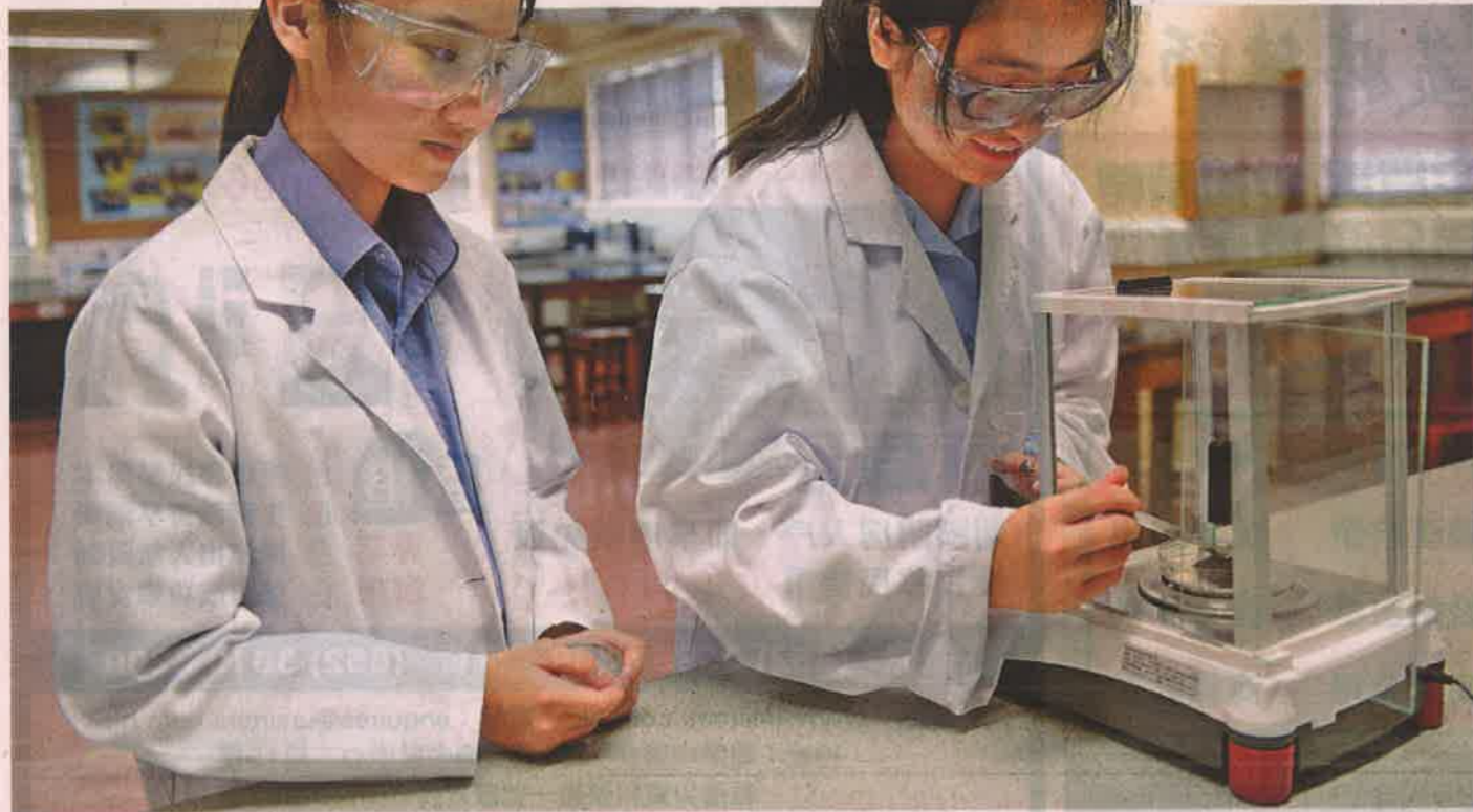
呂敏熹(右)在學校實驗室量度咖啡渣在吸入熱氣後的重量變化。
