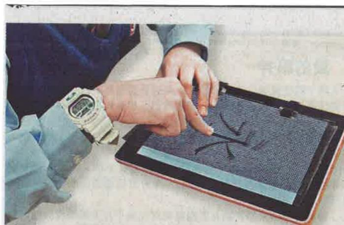
■「無障礙觸感文字認知器」有助讀寫障礙學生練習寫字，取代傳統製作費時的沙紙字卡，有望被廣泛使用。
